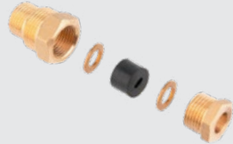
Арт. 51-0610-2 Сальник с двойной резьбой 1/2" и 3/4" для ввода кабеля в трубу
